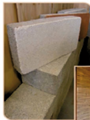
Boîtes de terre crue (briques)
